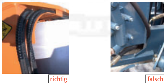
Abbildung 10: Vermeidung von Abknicken oder Scheuern
