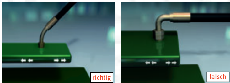
Abbildung 15: Verlegung bei Schwingungen
